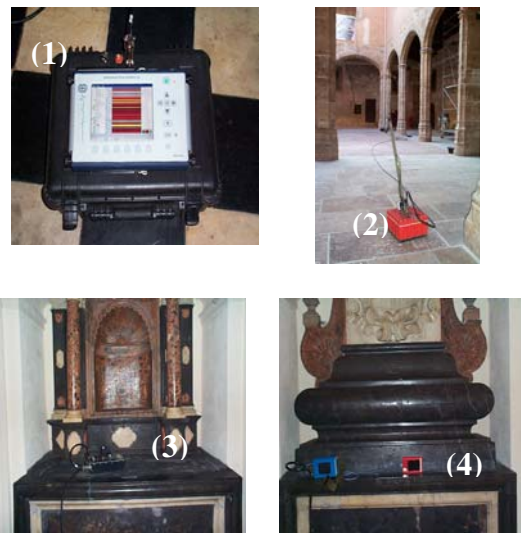
Figura 1. Ejemplo de equipo de georradar: (1) unidad central sistema SIR3000; (2) antena 400 MHz; (3) antena 900 MHz; (4) antena 1,5 GHz
